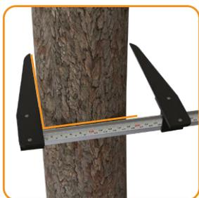
Colocar de manera perpendicular al tronco del árbol, apoyando la paleta fija en él
